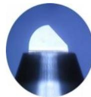
開発した加工工具の先端(単結晶ダイヤモンドエンドミル)
